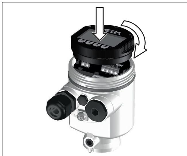
Рис. 31: Установка модуля индикации и настройки в отсеке электроники однокамерного корпуса
