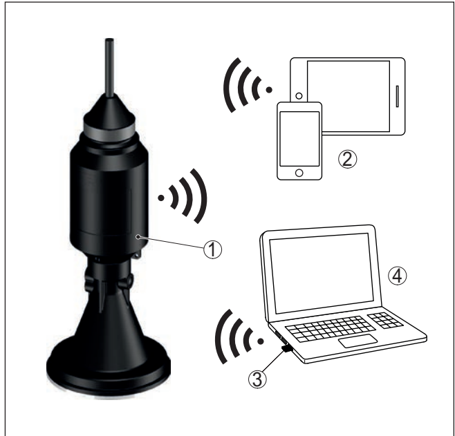
Рис. 3: Беспроводное соединение со стандартными устройствами для настройки
