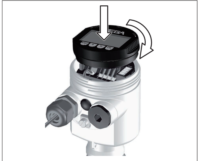
Рис. 4: Установка модуля индикации и настройки
