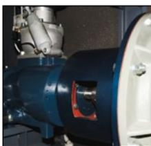
Электродвигатель и винтовой блок соединены между собой кулачковой муфтой и вращаются с одинаковой скоростью 2980 об/мин.
