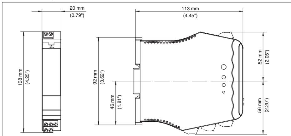
Рис. 20: Размеры VEGATOR 111
